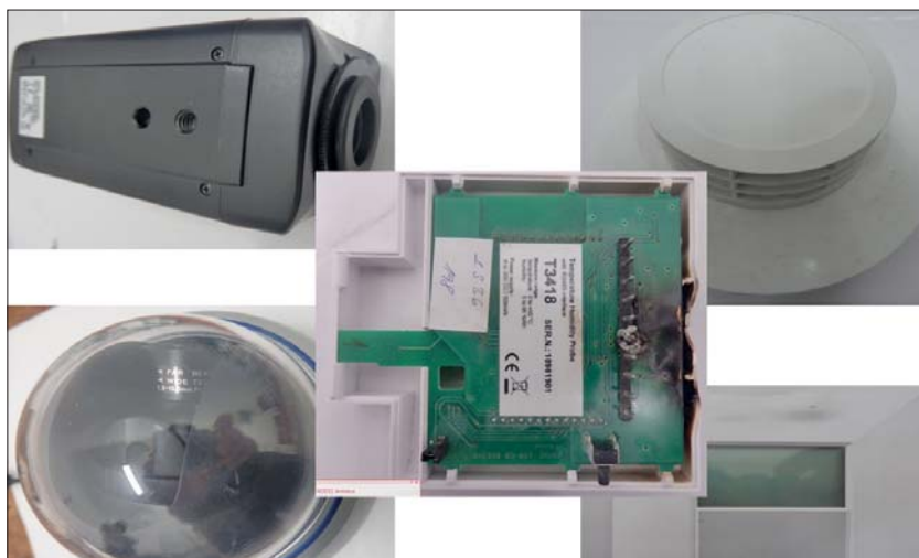
Obr. 1 Zcela poškozené kamerové a zabezpečovací systémy kulturní památky
